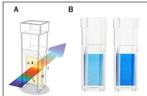
**Abb. 2: A) Strahlengang durch die DiluCell™.**
