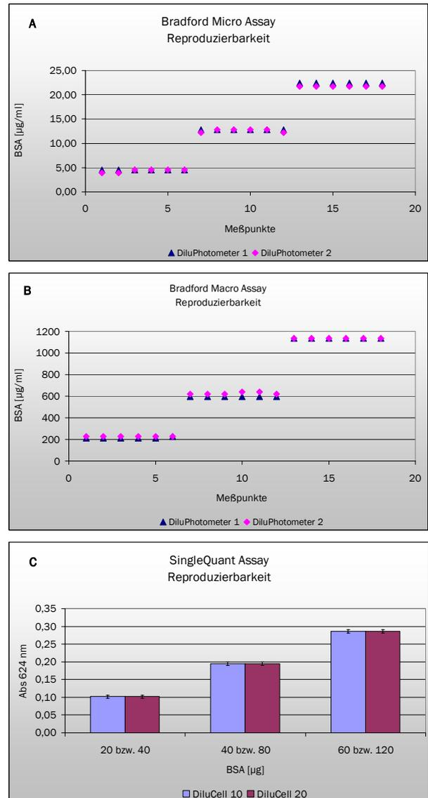
**Abb. 4:** Die Reproduzierbarkeit des Bradford- und des SingleQuant-Assays wurde durch mehrmaliges Vermessen von BSA-Lösungen dargestellt. **A + B**) Für den Bradford Micro- und Macro-Assay wurden je 3 unterschiedliche BSA-Konzentrationen in 2 unabhängigen Analyse-Ansätzen je 6-fach vermessen. **C**) Der SingleQuant-Assay wurde mit 5 verschiedenen BSA-Mengen durchgeführt. Pro BSA-Menge wurden 3 unabhängige Assay-Ansätze analysiert und jeder Ansatz in 6 unabhängigen Einzelmessungen vermessen.
